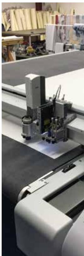
De wanden en daken van de voortent hebben een dikte van 780gr per m<sup>2</sup>, worden heel precies (computer gestuurd) versneden en uitgetekend met de beste software. De naden zijn op cruciale punten dubbel versterkt.
